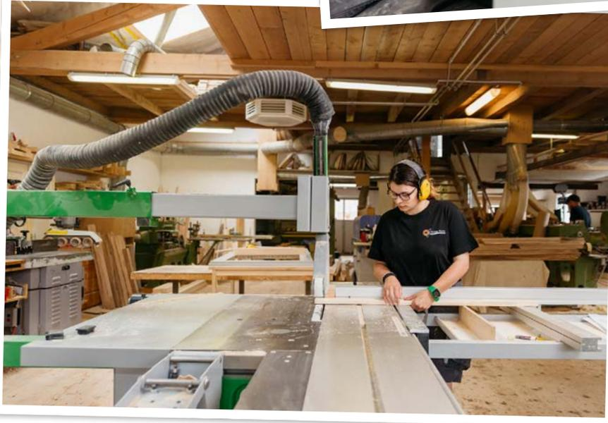
Die Kreissäge wird zum Schneiden von Holz sowie zur Herstellung von Winkeln und Rundungen verwendet.
