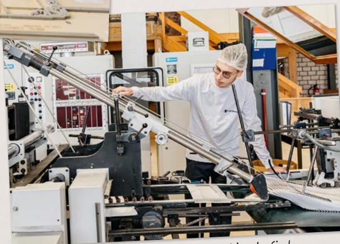
Die Zuschnitte, die sich in der Klebmaschine befinden, kontrolliere ich auf Fehler.
