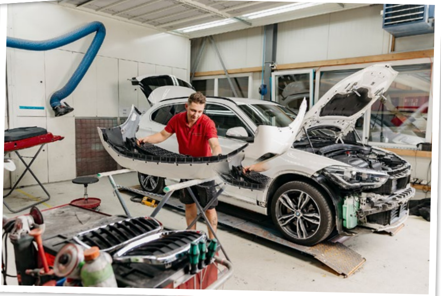
Die Abdeckungen werden aus der abmontierten Stossstange entfernt.
